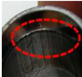
Rebarbas e defeitos internos
