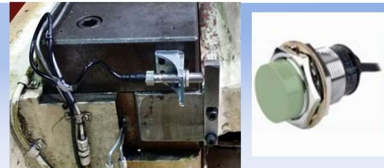
2.1 Via sensor piezo - Força de conformação (instalado em cunha ou espaçador ou carro)
