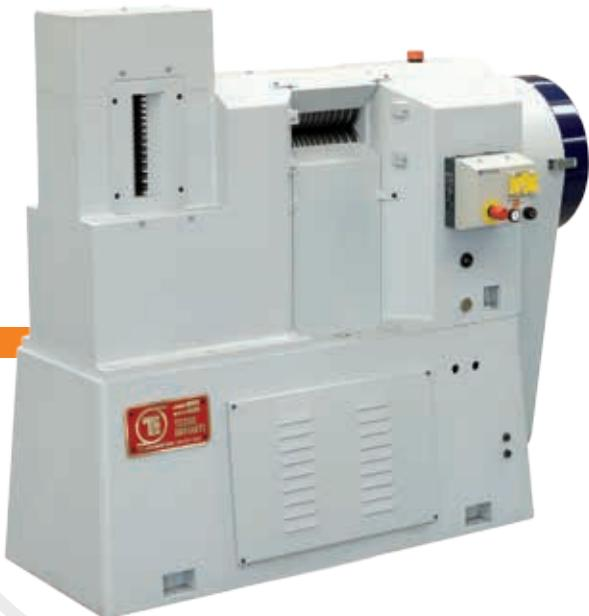
Las máquinas sacapuntas Mod. AT se utilizan para hacer la punta al alambre por laminación, antes de introducir el alambre en la hilera de trefilado.
